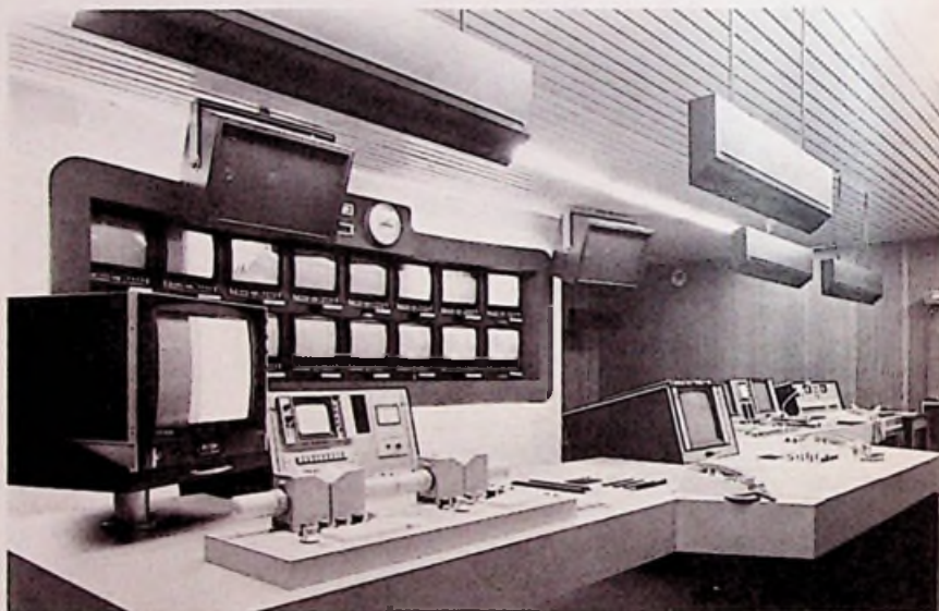
Regiekamer, met op de voorgrond de afstandbedieningen voor camera en episcoop en verder op de lessenaar de computergestuurde beeld- en geluidsmenger. Op de achtergrond de panoramische monitorwand.
